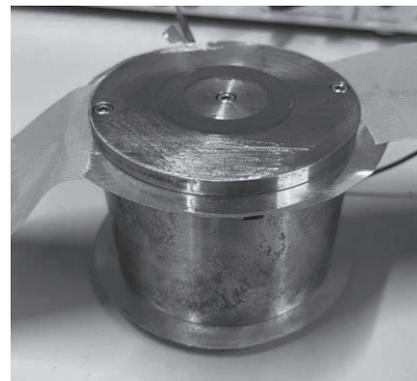
図 7 積層化した MRE を取り付けけた振動低減装置
